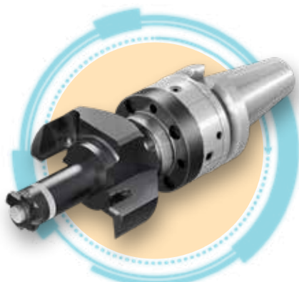
Комбинированный инструмент с напайными кромками из PCD для внутреннего и наружного развёртывания, и сменной головкой для нарезания канавок
